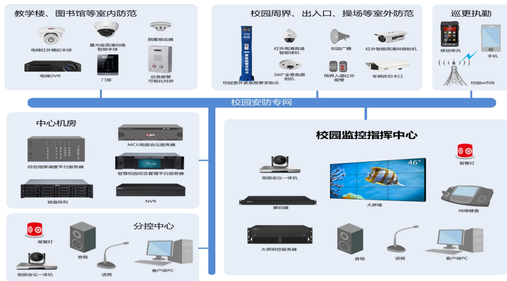
图8 连云港中专办学点可视化监控指挥中心照片及功能拓扑图
